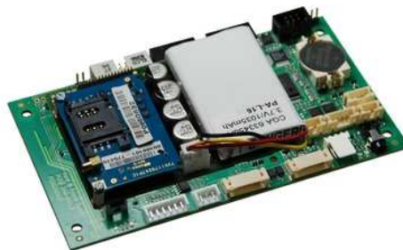
Die FTL VMC Platine mit installierter Modemeinheit
